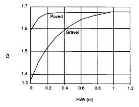
B) Discharge Coefficient for  $HW_f/L_f \le 0.15$
