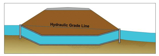
Figure 5.2. Sag culvert.
